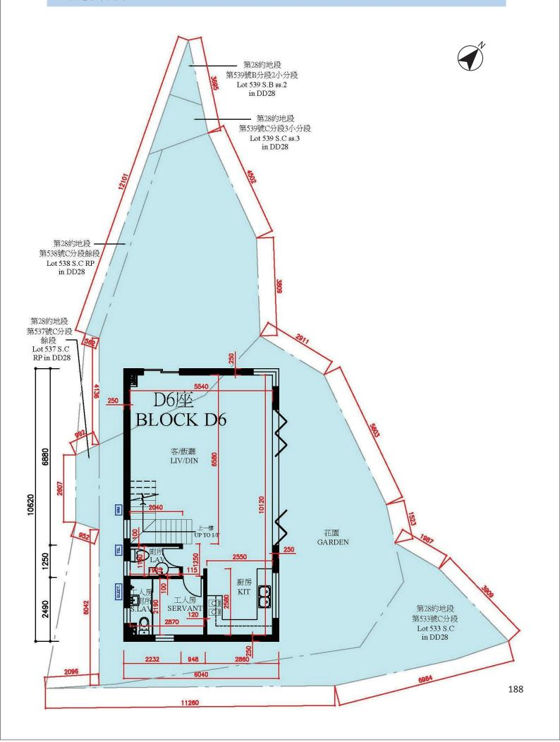
Block D6\* Ground Floor Plan D6\*座地下平面圖
