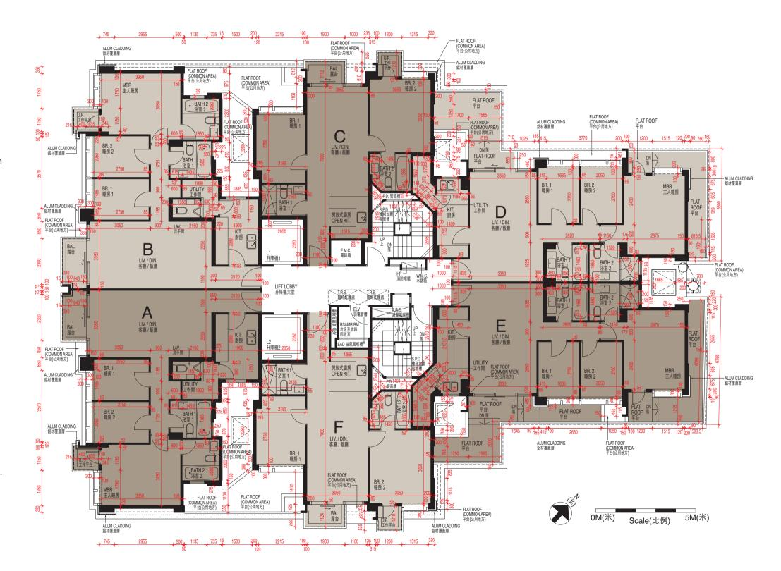
每個住宅物業的樓板 (不包括灰泥) 的厚度: 6樓至10樓A、B、D及E單位: 150毫米及175毫米 6樓至10樓C及F單位: 150毫米
