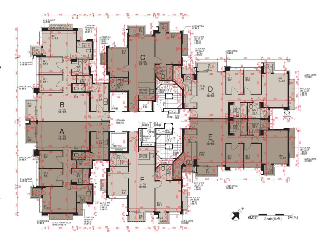
每個住宅物業的樓板 (不包括灰泥) 的厚度: 11樓至18樓A、B、D及E單位: 150毫米及175毫米 11樓至18樓C及F單位: 150毫米
