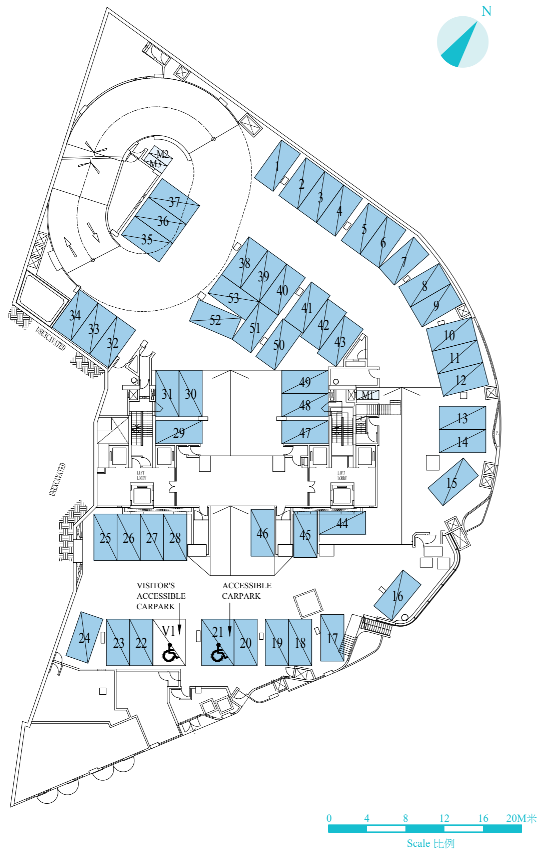
Number, Dimensions and Area of Parking Space 停車位的數目、尺寸及面積
